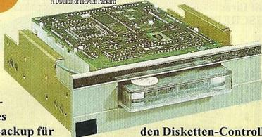
Preiswertes PC-Backup für den Disketten-Controller, QIC 80 interchange standard (QIC 40 lesen), Industrie-Standard (DC-2000) Technologie, meist gekauftes Mini-Data-Cartridge Gerät weltweit, Colorado Software
