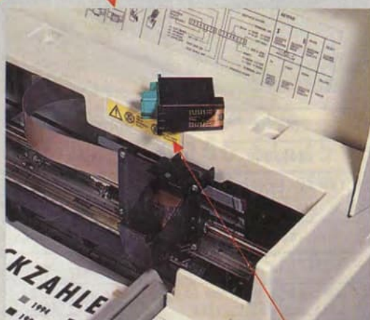
Bei Tintenstrahldruckern mit Bubble-Technologie ist der Druckkopf fest mit der Tintenpatrone verbunden.
