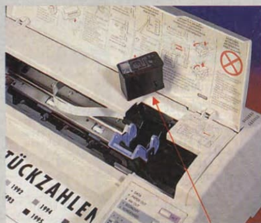
Der Piezo-Druckkopf ist fest im Drucker installiert. Das spart Folgekosten und ist umweltschonend.
