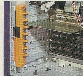
Erweiterungskarten schnell wechseln: Mit dem Sky-Schnellverschluss ist dazu kein Werkzeug nötig.
