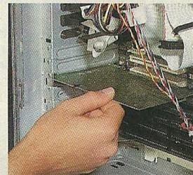
Sie stecken die Erweiterungskarten auf die Rechnerplatine, mit dem Sky-Schnellverschluss (Quick-Release) werden die Karten fixiert.
