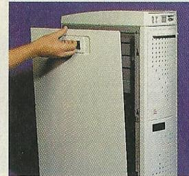
Die Seitenteile des SkyTowers sind gesteckt und lassen sich mit einem Schnappverschluss in den Haltegriffen ruck-zuck herausnehmen.
